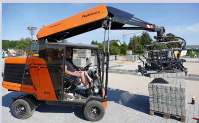
Lasten werden per Joystick statt Fußpedal gehoben und gesenkt. Foto: Optimas
