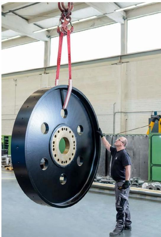
SupraPlus-X mit neuen Eigenschaften: zum Beispiel verstärkte Rippen in der Schlauchhülle und deutlichere Kennzeichnung der Nenntragfähigkeit.
