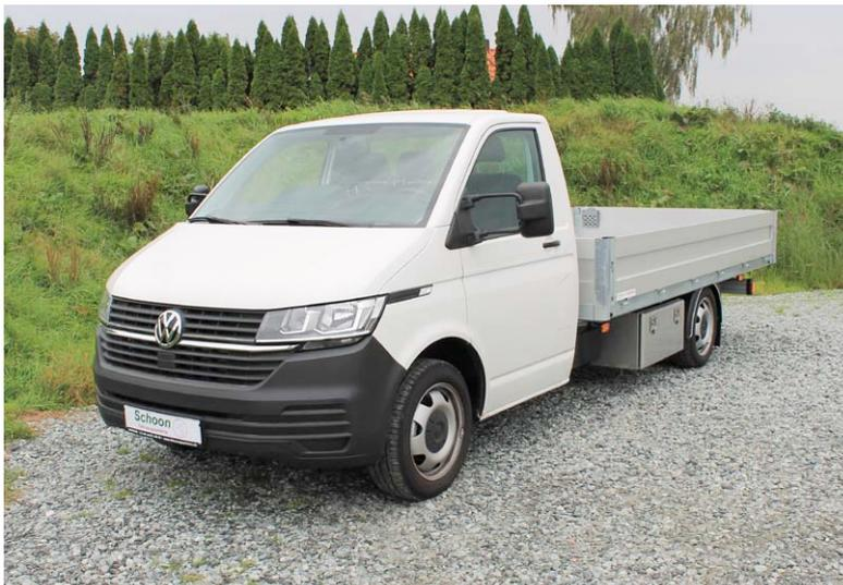
und sorgt für Sicherheit und Komfort. Für ein bequemes Be- und Entladen der Fahrzeuge ist in Verbindung mit einem Hilfsrahmen der Anbau einer Ladebordwand möglich. Die Feuerverzinkung von Rahmenanbindung und Chassis-Komponenten sorgt zudem für zuverlässigen Korrosionsschutz und damit verbunden laut Hersteller auch für eine lange Lebensdauer.
